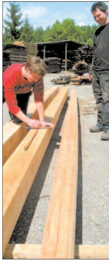
Vom Kantholz zum Segelbaum. Ulrike Wankmüller und Daniel Jäck bearbeiten derzeit heimische Lärchen für das historische Segelschiff Hansine. Der so genannte Haikutter bekommt eine aufwändige Restauration, bevor er wieder seetüchtig ist. Fotos: Krauss/privat
